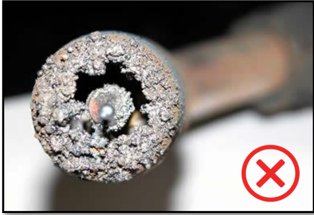
Şekil-3 Nozül temizliği periyodik olarak yapılmalıdır
