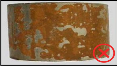
Şekil-2 Kaynak edilecek parçanın yüzeyi temiz olmalıdır
