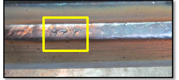
Şekil-1 Kurtçuk görüntüleri. Alın kaynağı (solda), köşe kaynağı (sağda)
