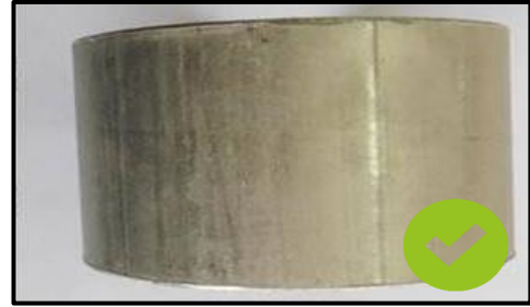
Şekil-2 Kaynak edilecek parçanın yüzeyi temiz olmalıdır
