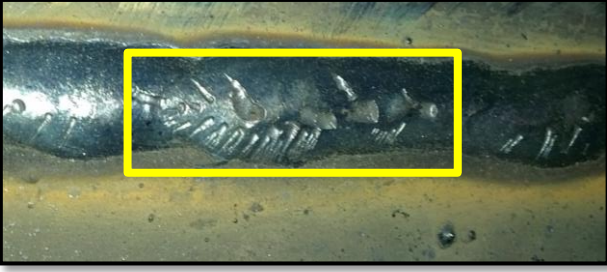
Şekil-1 Kurtçuk görüntüleri. Alın kaynağı (solda), köşe kaynağı (sağda)
