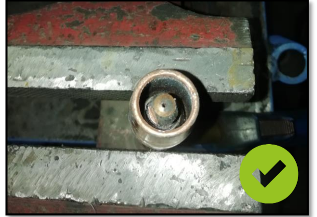
Şekil-3 Nozül temizliği periyodik olarak yapılmalıdır
